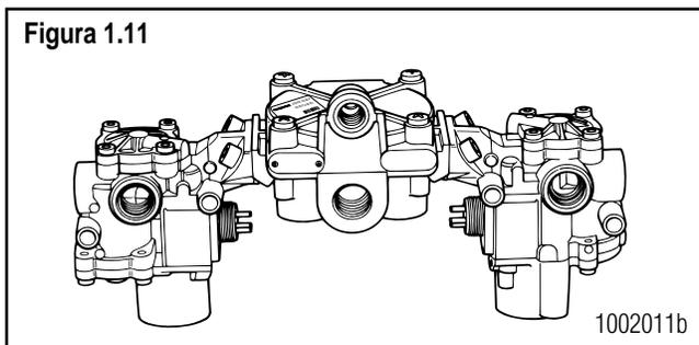
El Conjunto de Válvulas ABS es una alternativa a las válvulas individuales sobre el eje trasero. Combina dos válvulas modificadoras ABS y una válvula relevadora de servicio. **Figura 1.11.**
