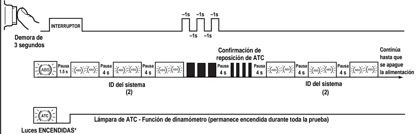
\*La lámpara de ATC sólo se encenderá si el ATC está conectado.
