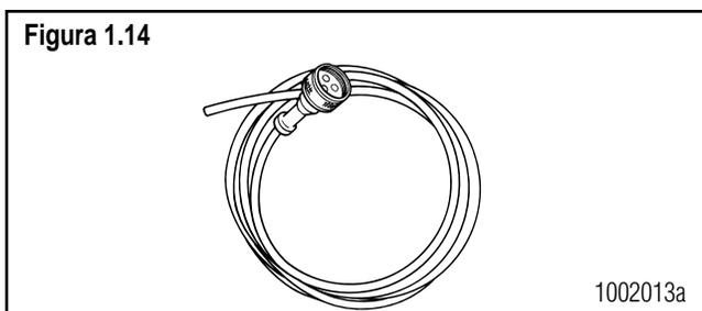
Los cables de la válvula modificador ABS conecta esta válvula con el ECU. **Figura 1.4.**
