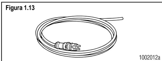
Los cables del sensor conectan a éste con el ECU. **Figura 1.13.**
