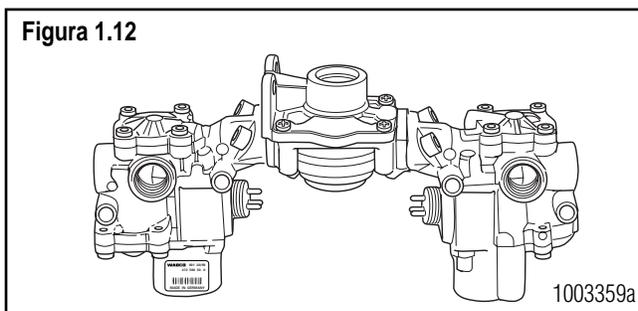
**El conjunto de válvulas ABS delanteras** combina dos válvulas modificadoras y una válvula de desconexión rápida. **Figura 1.12.**
