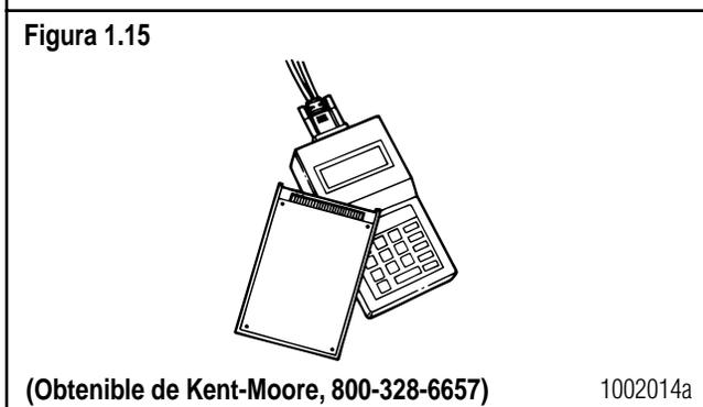
El MPSI Pro-Link® 9000 con cartucho Meritor WABCO proporciona capacidad de diagnósticos y pruebas para el sistema ABS. **Figura 1.15.**
