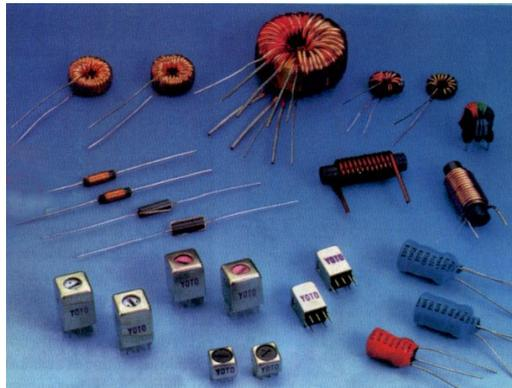
La bobina es un elemento muy interesante. la bobina por su forma (espiras de alambre arrollados) almacena energía en forma de campo magnético. Todo cable por el que circula una corriente tiene a su alrededor un campo magnético generado por la mencionada corriente, siendo el sentido de flujo del campo magnético el que establece la ley de la mano derecha.
