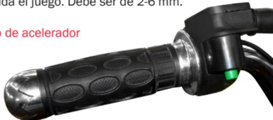
Para ajustar retire el cobertor de la tuerca, suelte la tuerca y gire el ajustador.
