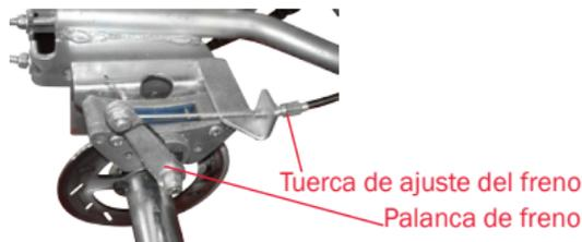
El sistema del freno trasero es por accionamiento mecánico.
